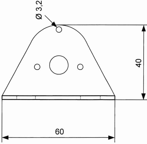
\*die Maßen der Bohrungen müssen an den Elektromotor angepasst werden!!!
